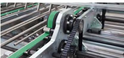
Unsere Spannsätze werden weltweit in den unterschiedlichsten Verpackungsmaschinen verbaut. Beispielsweise zur Befestigung von Riemscheiben sowie zur Beförderung von Waren innerhalb der Maschinen. Darüber hinaus kommen auch Schrumpfscheiben und Wellenkupplungen zum Einsatz.
