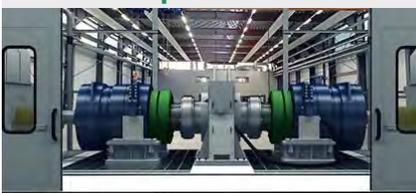
Unsere hydraulischen Schrumpfscheiben, speziell für Getriebeprüfstände, werden nach Kundenspezifikationen ausgelegt und gefertigt. Durch unser jahrelanges Know-How sind wir Weltmarktführer in diesem Bereich und stellen weltweit Prüfstände mit unseren Produkten aus.
