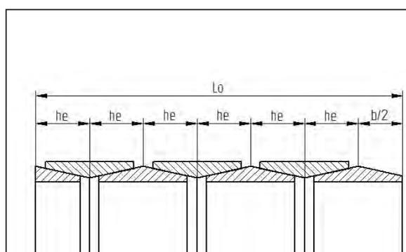
Bild 8: Reibungsfeder mit 6 Elementen, Enden 1 IR + 1 HIR
